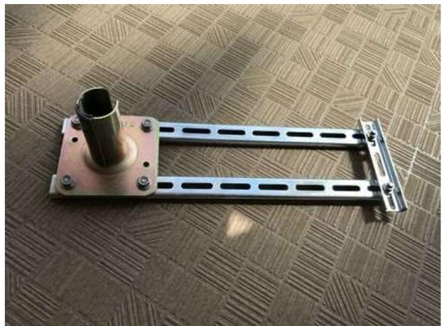
実際に 50MHz の 4 エレ HB9CV を取り付けても安定する事を目標に、補強用パイプをエンビのパイプを加工しました。固定ベースとエンビパイプの隙間にテンション掛かるように、エンビパイプをカットし輪切りにして固定しました。エンビパイプを取り付けるとガタが無くなりました。
