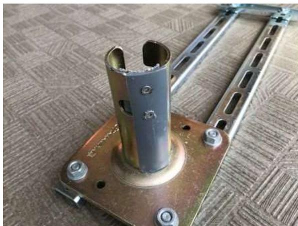
次に、移動用の伸縮ポールを差込むと、エンビパイプ上部にガタ付きがあるので、6mm のボルトを両側から止められる様に穴を開けてナットを接着剤で止める事にしました。
